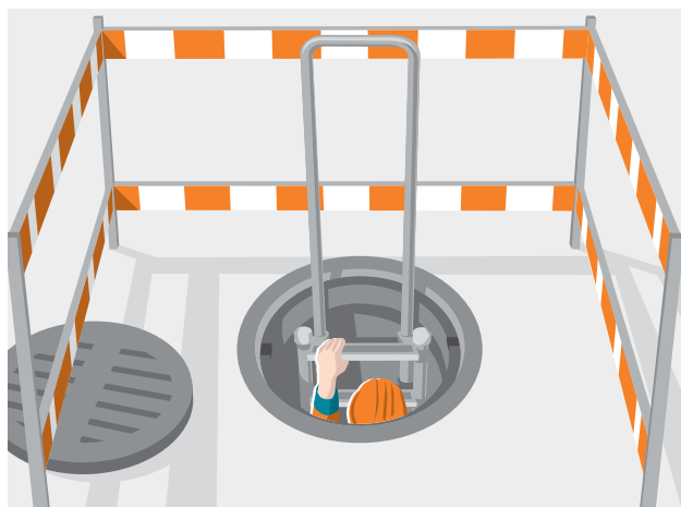
1 Accesso sicuro a una scala per pozzetti con ausilio di accesso
