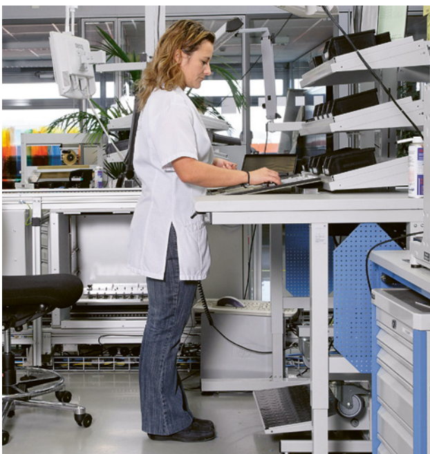
Fig. 10 et 11: les postes de travail doivent permettre d'alternier les positions assise et debout, comme ici pour le montage de précision.
