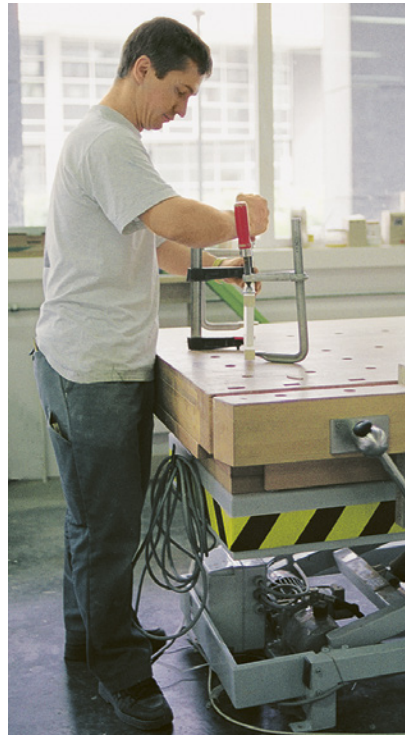
Fig. 14, 15 et 16: la hauteur de cet établi est modulable en fonction des tâches à effectuer.
