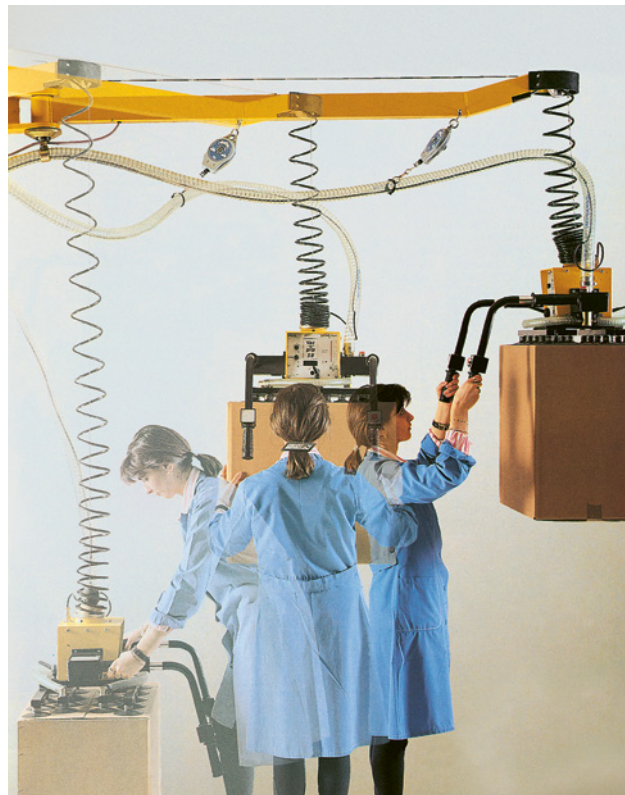
Fig. 22: l'équilibreur de charges permet de déplacer des charges avec un minimum d'efforts.
