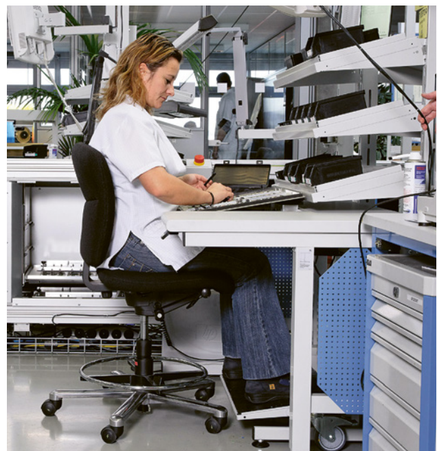
Fig. 10 et 11: les postes de travail doivent permettre d'alternier les positions assise et debout, comme ici pour le montage de précision.
