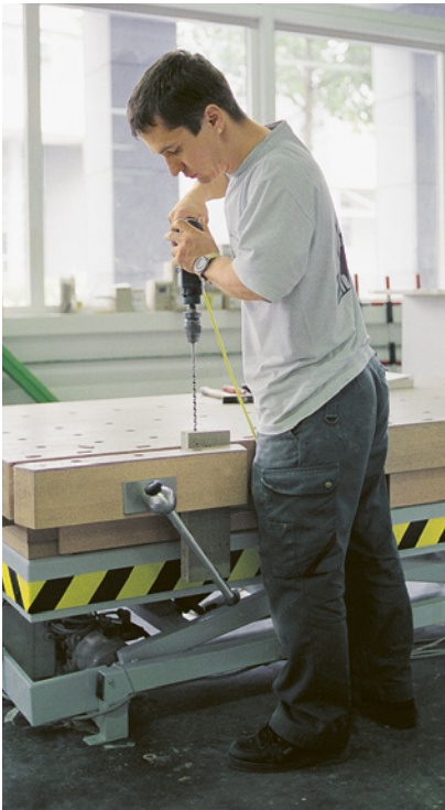
Fig. 14, 15 et 16: la hauteur de cet établi est modulable en fonction des tâches à effectuer.
