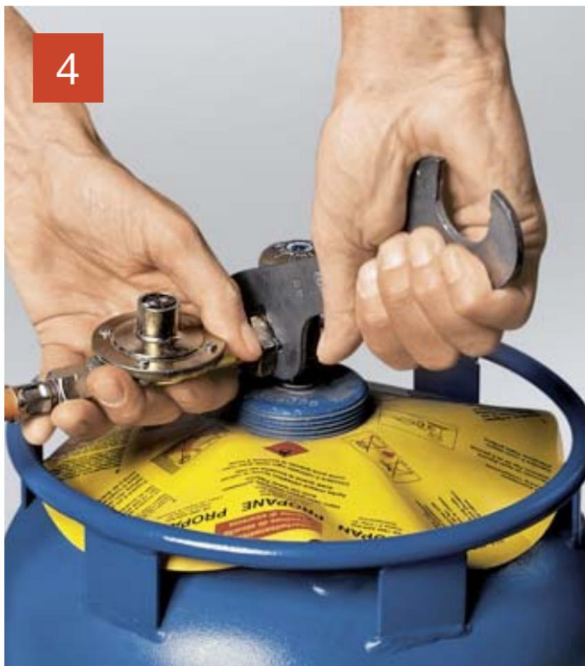
Pour un écrou six pans: avec une clé à fourche.
