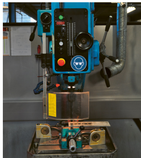
4 Dispositivo di protezione interbloccato: copertura girevole del trapano
