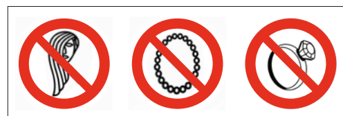
7 Legare o proteggere i capelli lunghi. È vietato indossare collane e braccialetti quando si usa il trapano.
