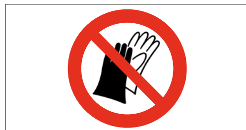
6 È vietato usare i guanti con la macchina in funzione.
