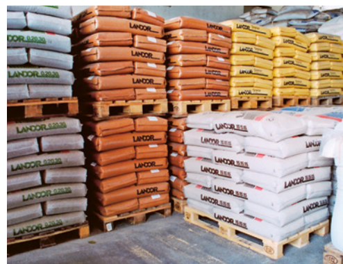
5 Lagerung von Säcken auf Holzpaletten. Um die Qualität des Produkts nicht zu beeinträchtigen, ist die Höhe der Stapel auf zwei Palette beschränkt worden.
