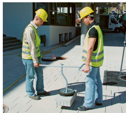
5 Sollevatore a ventosa per il trasporto di carichi in due
