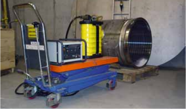
Industrielle Röntgenanlage im Prüfeinsatz
