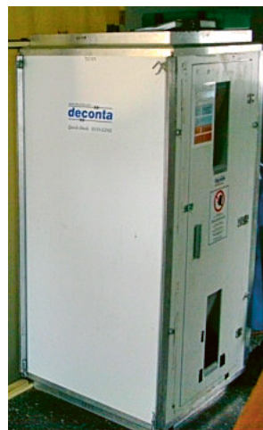
2 Accesso alla zona da bonificare (unità di decontaminazione, a tenuta stagna)
