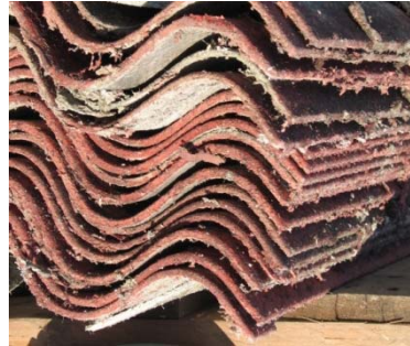
4 Rifiuti di amianto non imballati
