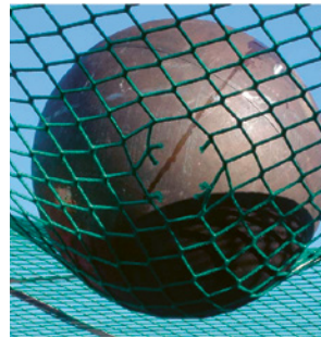
5 Fallversuch mit 100-kg-Kugel beim Systemtest (Fallhöhe 2,5m)
