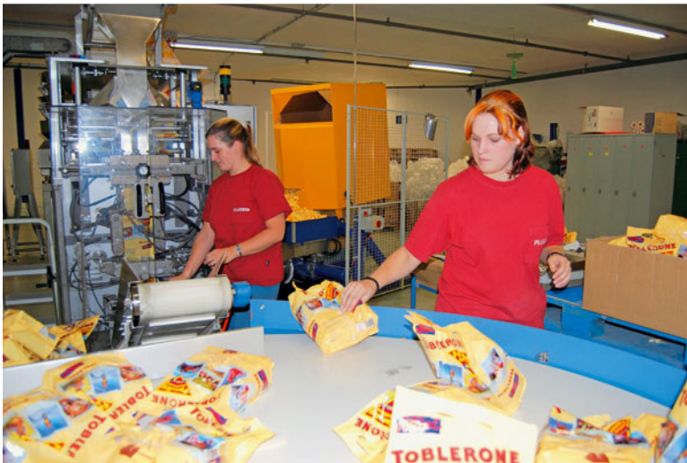
Gefährliche Bereiche sind eingehaust; bei geöffneter Schutzeinrichtung läuft die Maschine nicht.
