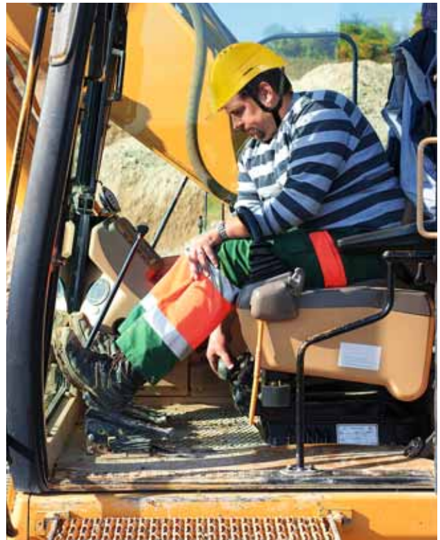
Image 19 les sièges amortissant les vibrations doivent pouvoir être réglés en fonction du poids du conducteur.
