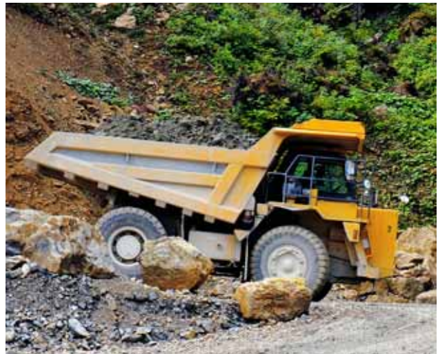
Image 14 le fait d'adapter sa conduite dans les terrains accidentés peut considérablement réduire les vibrations.
