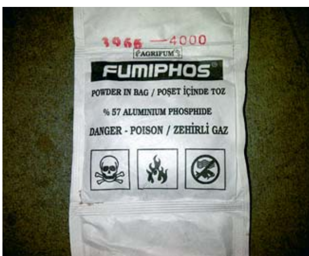
Fig. 2: sacchetto rinvenuto in un container merci contenente l'agente fumigante fosfuro di alluminio (rilascia liberamente fosfina in presenza di umidità nell'aria).
