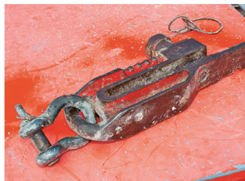
3 Manille de sécurité utilisée pour le levage des tubes, pieux forés et autres accessoires.
