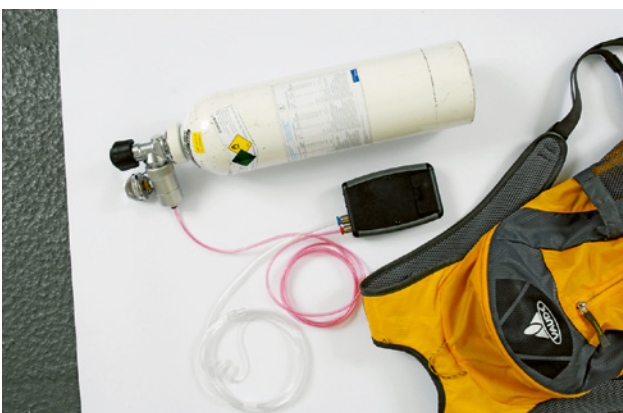
4 On-Demand-Sauerstoffapplikationsgerät mit Tragrucksack für die Sauerstoffflasche.
