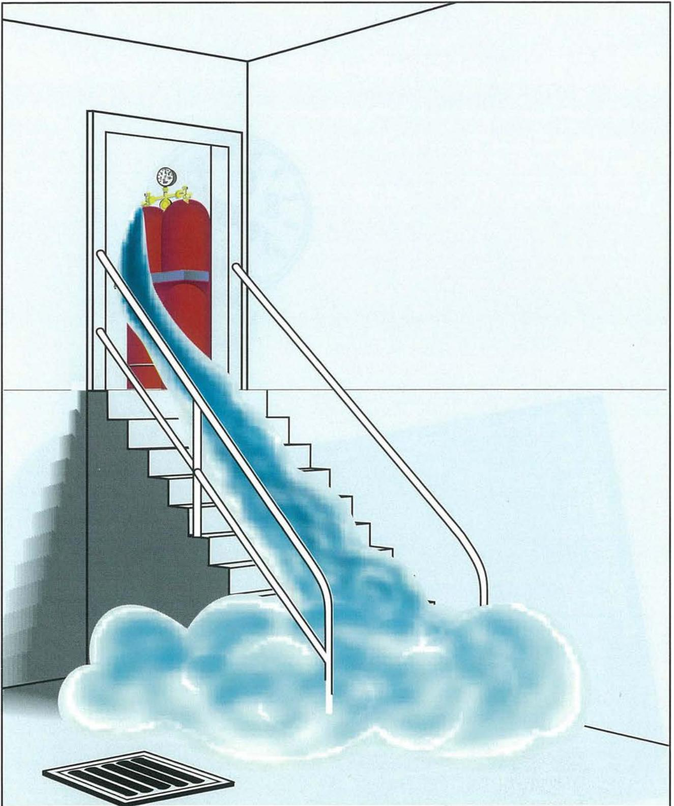
Figura 7: Forma de propagación de los gases licuados
