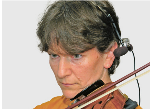
52 Microphone fixé sur un arceau utilisé pour mesurer la charge sonore à proximité de l'oreille d'une musicienne en train de jouer
