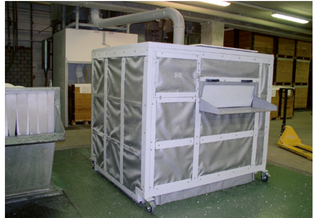
71 Encoffrage d'un broyeur de déchets plastiques. Le niveau sonore a baissé d'environ 12 dB(A).
