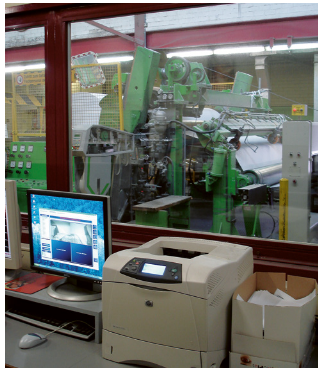
75 Local de commande d'une machine à papier. Le bruit de fond dans le local de commande s'élève à 65 dB(A), contre 90 dB(A) à l'extérieur du local.
