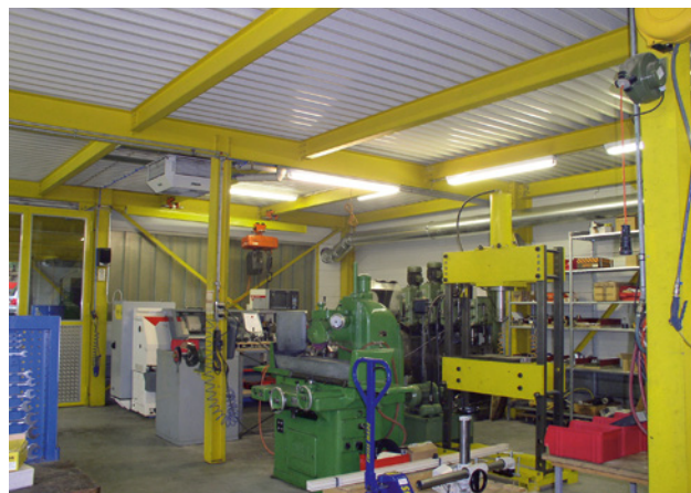
79 Local de fabrication courant: structure métallique avec tôle profilée, sans plafond acoustique efficace. Ce local est très réverbérant. Le bruit des machines est très gênant dans tout le local.
