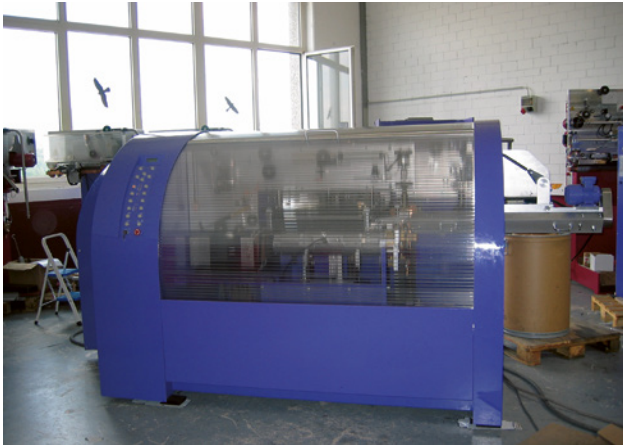
72 Encoffrage d'une machine fabriquant des boîtes de conserve. Le niveau sonore sur la partie externe de la machine a été réduit à 82 dB(A).
