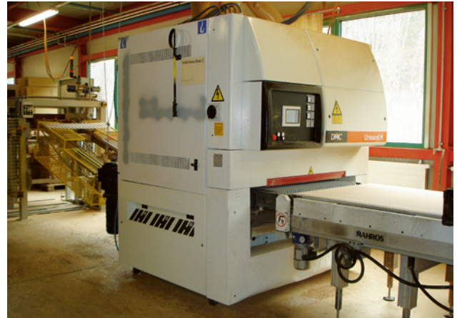
74 Rectifieuse plane totalement encoffrée servant à la fabrication de revêtements de sols
