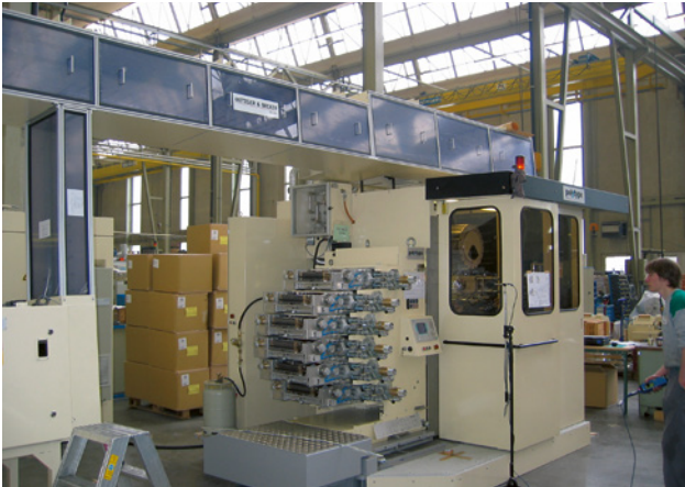
70 Encoffrage partiel d'une machine d'impression de tubes (200 tubes/min); à 1 m de distance, on mesure encore un niveau sonore de 77 dB(A).
