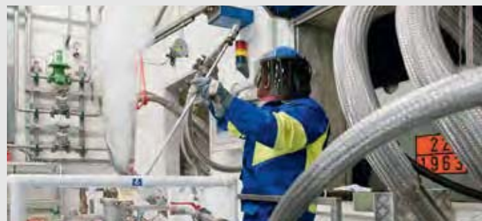
Transvasement d'hélium liquide (-269°C) dans l'unité de remplissage des gaz spéciaux.
