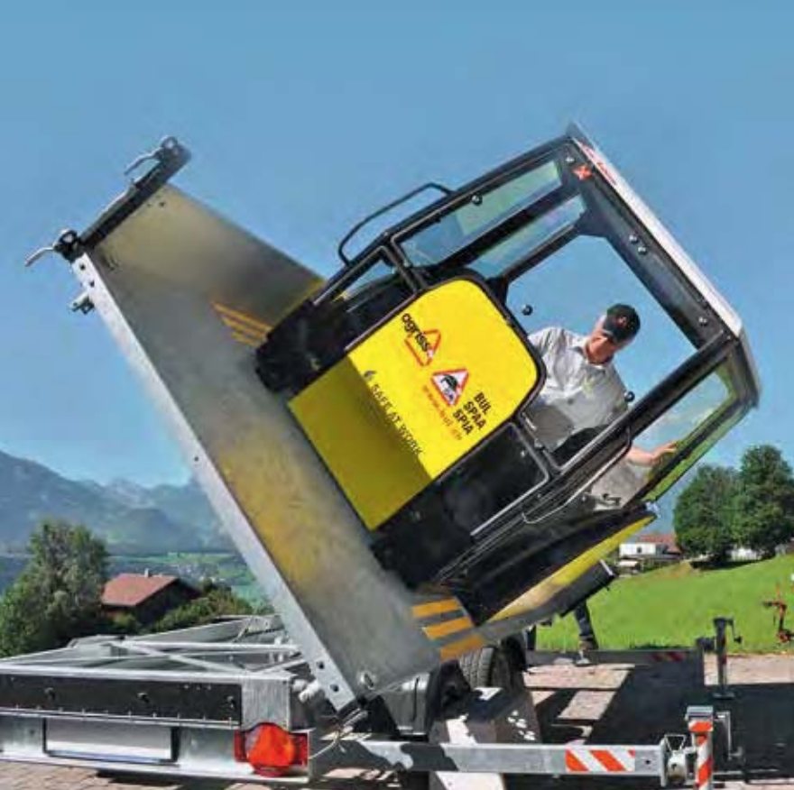
Le simulateur de tonneaux pour tracteurs permet de découvrir les effets d'une chute de tracteur sur le corps humain.
