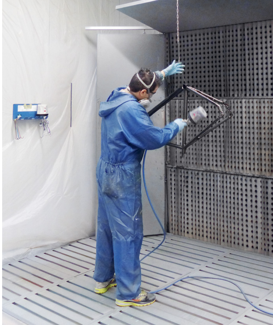
Estrattori correttamente posizionati prevengono la diffusione di sostanze pericolose.
