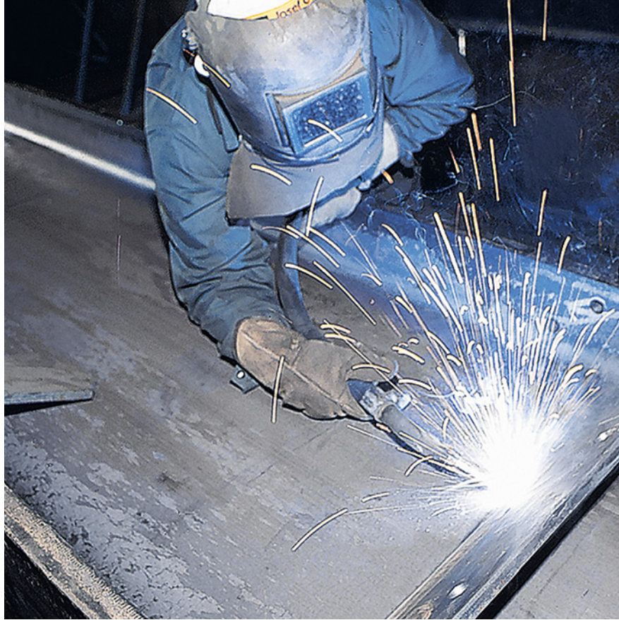
Le operazioni di saldatura generano sostanze nocive, che variano in funzione del procedimento adottato.
