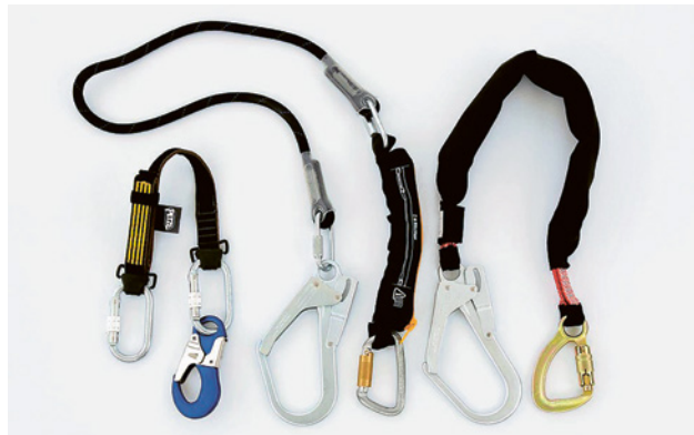
10 Nastro a strappo, integrato come assorbitore di energia in un cordino di posizionamento. Con un carico di circa 3 kN (300 kg) il nastro inizia a strapparsi.
