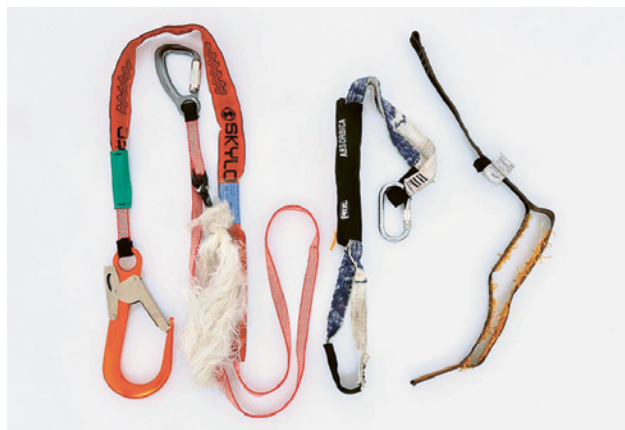
11 Esempi di ammortizzatori di caduta strappati. Lo strappo attutisce il contraccolpo.
