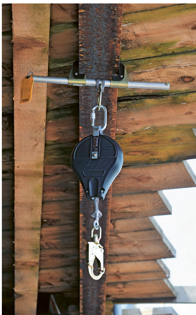
22 Dispositivo anticaduta di tipo retrattile montato su un punto di ancoraggio mobile
