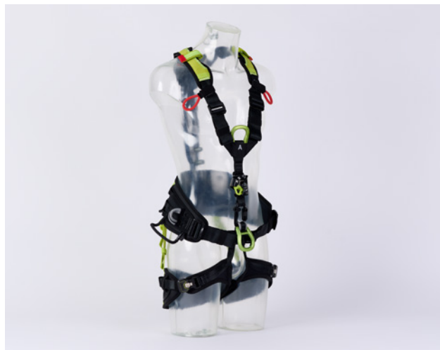
19 Imbracatura anticaduta combinata (SN EN 361) con cinghia toracica leggera, cintura (SN EN 358) e cintura con cosciali integrata (SN EN 813), elementi e anelli di fissaggio centrali e laterali
