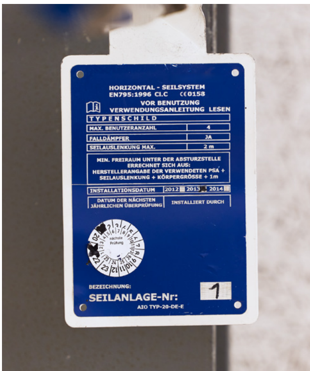
46 Targhetta del tipo di un dispositivo di ancoraggio permanente con etichetta di controllo
