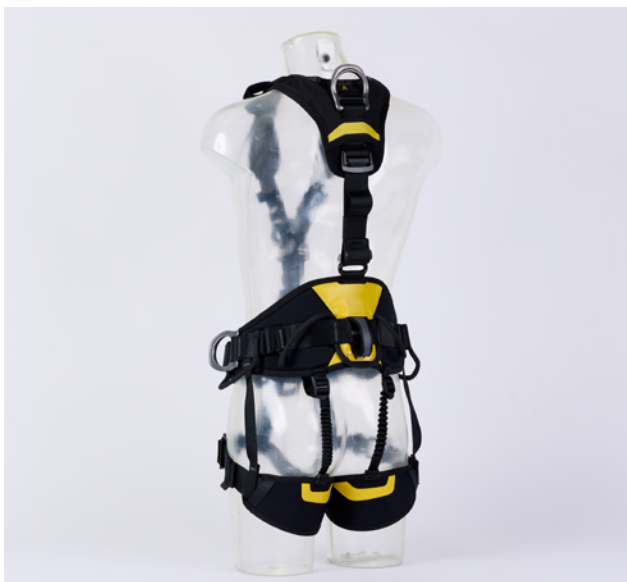
18 Imbracatura anticaduta combinata (SN EN 361) con cintura (SN EN 358) e cintura con cosciali integrata (SN EN 813)
