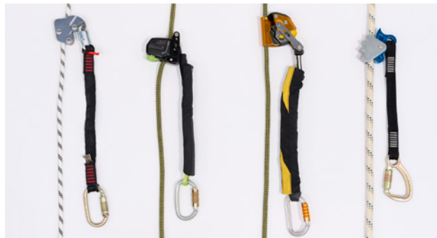
27 Dispositivo anticaduta di tipo guidato (SN EN 353-2) comprendente una linea di ancoraggio flessibile costituita da una corda con guaina (SN EN 1891)
