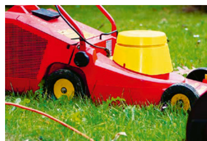
3 Risque d'électrocution, surtout en l'absence de dispositif différentiel résiduel (DDR)
