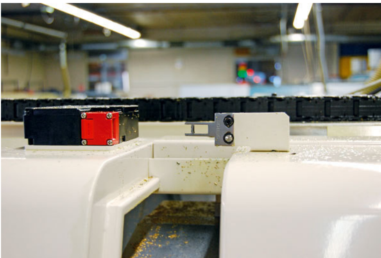
Die Maschine läuft erst, wenn das an der Schutzeinrichtung befestigte Gegenstück im Überwachungsschalter steckt.
