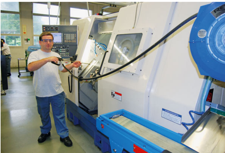
Hier stolpert keiner: Die Schlauchtrommel für die Reinigungsarbeiten ist erhöht angebracht.
