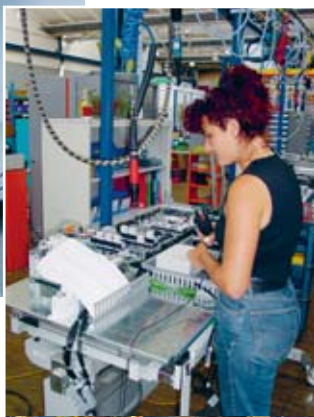
Figura 17 Banco di montaggio a regolazione elettrica.
