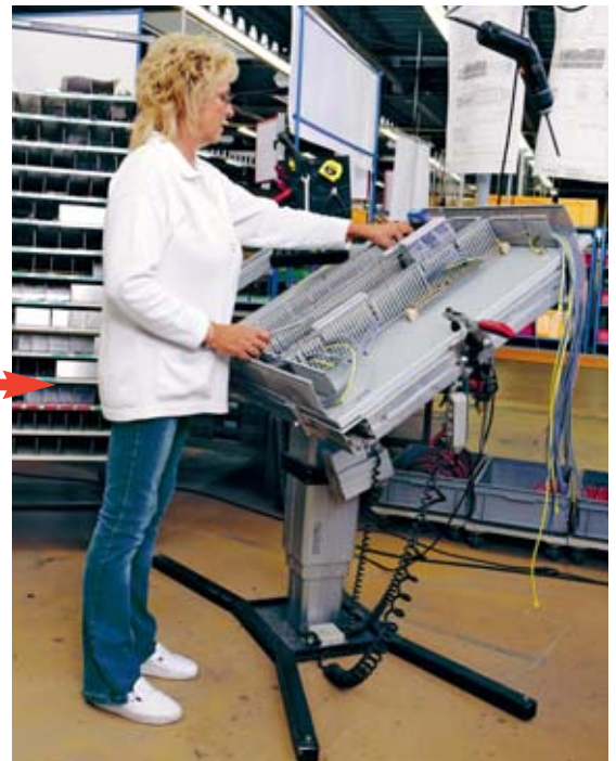
Figura 8 Il supporto di montaggio regolabile in altezza e inclinabile consente di mantenere una posizione corretta.
