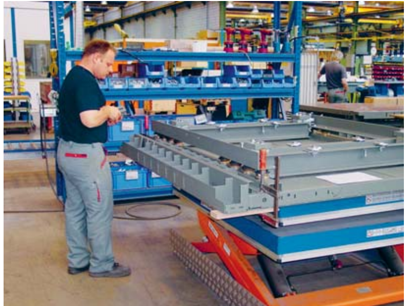
Figura 4 Una tipica postazione in piedi presso un banco su sollevatore a forbice.
