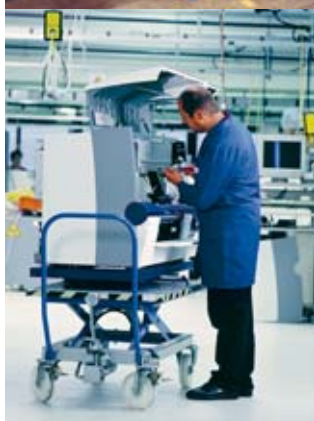
Figura 19 Carrello sollevatore con meccanismo di regolazione dell'altezza a pedale.
