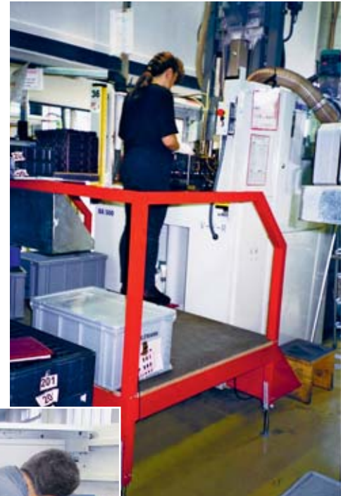
Figura 20 Pedana con meccanismo di regolazione elettrico.
