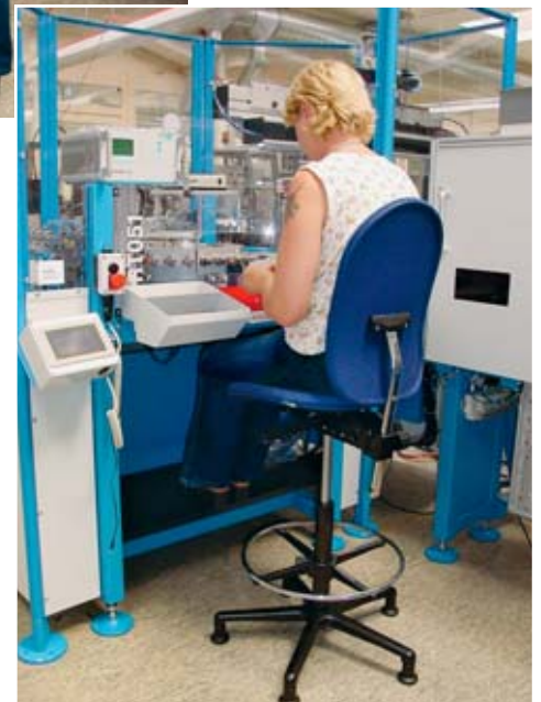
Figura 25 Grazie al corretto posizionamento del piano di seduta e al poggiatesta è possibile lavorare seduti ad un'altezza pari a quella di una persona in piedi.
