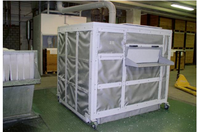
71 Kapselung einer Mühle für Kunststoffabfälle. Erzielte Pegelsenkung: zirka 12 dB(A)
