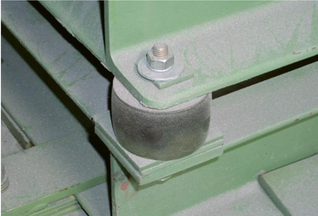
68 Gummielement für die Lagerung eines Ventilators
