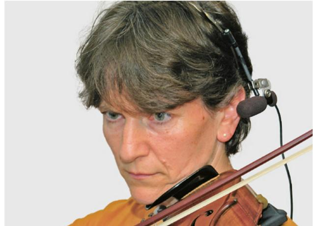
52 An einem Kopfbügel befestigtes Messmikrofon zur ohрнаhen Messung der Schallbelastung beim Musizieren
