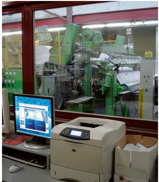
**75** Leitwarte einer Papiermaschine. Der Grundpegel beträgt 65 dB(A), während aussen Schallpegel von rund 90 dB(A) herrschen.
