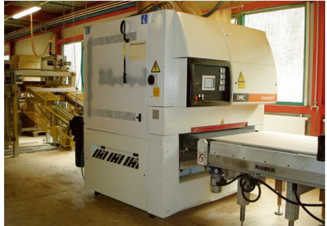
**74** Gekapselte Flachsleifmaschine zur Herstellung von Bodenbelägen
