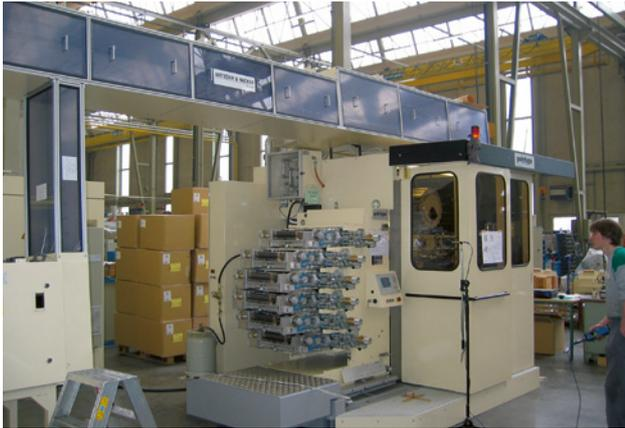
70 Teilkapselung an einer Tubendruckmaschine (200 Tuben/min); in 1 m Abstand wird noch ein Schallpegel von 77 dB(A) gemessen.
