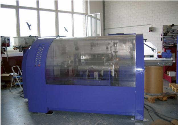
**72** Kapselung eines Dosenschweissautomaten. Durch die Kapselung wird der Schallpegel auf der Aussenseite auf 82 dB(A) reduziert.
