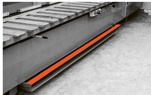
1 La couverture sur la barre d'enclenchement prévient un démarrage intempestif.
