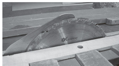
7 lame de scie sans cape de protection en position initiale, mais avec couteau diviseur correctement réglé recouvrant le dessus de la lame. Lors de la sortie de la lame, ce couteau diviseur disponible auprès du fabricant garantit une meilleure couverture de la lame. La cape fixe au-dessus de la sortie de la lame constitue toujours la solution la plus efficace.
