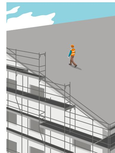
**2** A partire da un'altezza di 2 m mettiamo in sicurezza le zone con rischio di caduta a bordo tetto
