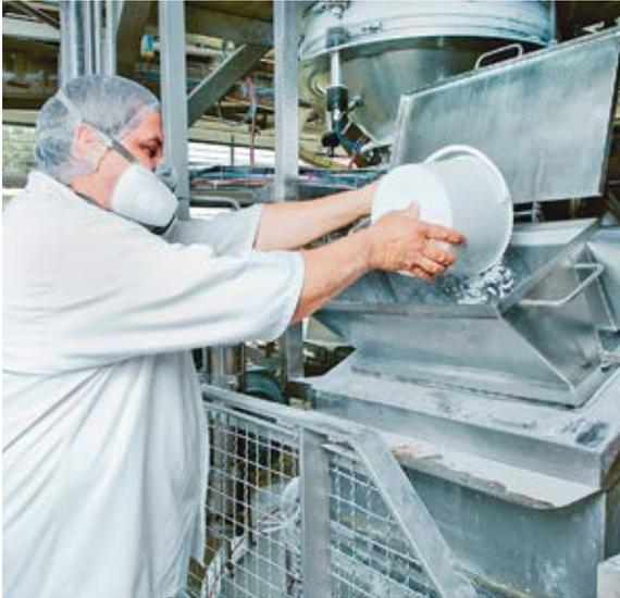
1 Arbeiter füllt eine Pulvermischung aus 10 % Thaumatin und 90 % Gummi arabicum in eine Knetmaschine, wo die verschiedenen Zutaten zu einer Kaugummimasse verarbeitet werden.
