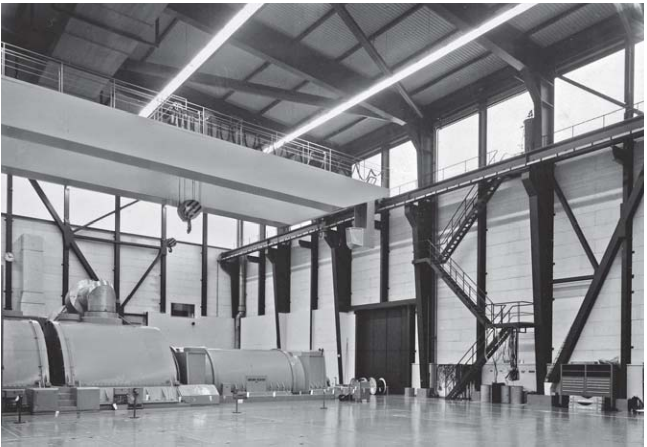
11 escalier permettant d'accéder au poste de commande et aux plates-formes de service sur un pont roulant bipoutre.
