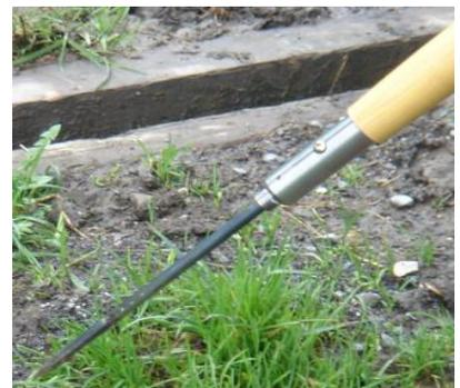
I 4 controlli vanno obbligatoriamente eseguiti prima di salire sui pali: a. Controllo visivo; b. Battitura; c. Spinta dei pali e d. Controllo con la sonda dei pali (ferro a punta). Solo così facendo si contribuisce concretamente alla prevenzione di infortuni!
