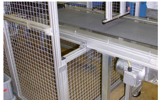
7 L'apertura al di sotto del convogliatore di scarico deve essere chiusa da una grata.
