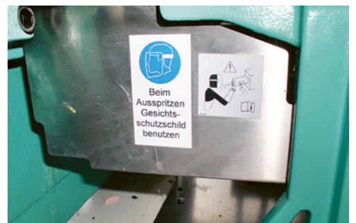
8 L'addetto all'unità di iniezione deve proteggersi dagli schizzi di materiale incandescente con una visiera di protezione, i guanti di protezione e indumenti di lavoro chiusi.
