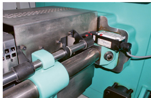
4 Quando si sposta il riparo, il controllo elettrico deve arrestare l'avanzamento dell'unità di iniezione.
