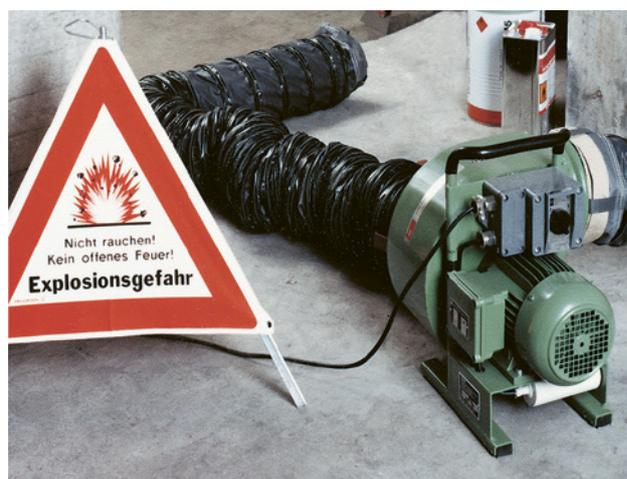
18 Utilisez un ventilateur antidéflagrant contre le risque d'explosion. L'aspiration doit être systématique; elle est beaucoup plus efficace que l'injection d'air frais.
