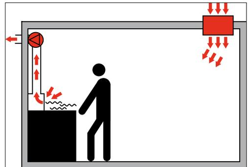
2 La direzione del flusso d'aria è determinante per l'efficacia degli impianti di ventilazione.
