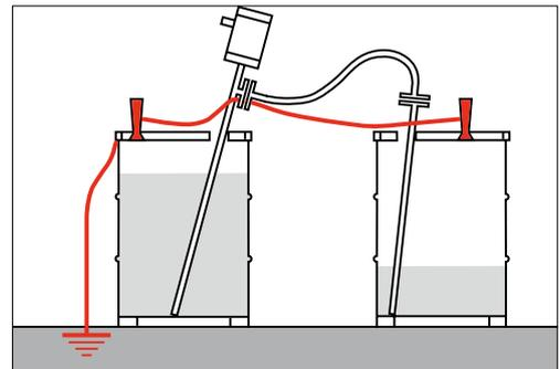
4 Il collegamento equipotenziale e la messa a terra sono misure importanti contro la formazione di cariche elettrostatiche che possono provocare esplosioni.
