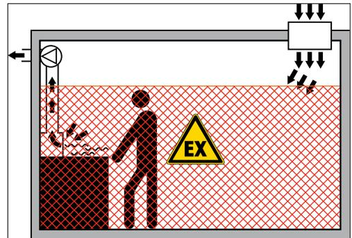
3 Occorre adottare misure appropriate per evitare la presenza di fonti d'innesco nelle zone con pericolo di esplosione.
