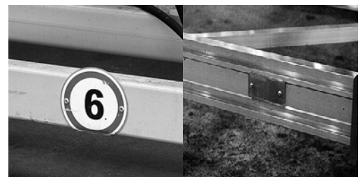
4 Signalisation précise de la vitesse maximale et réflecteur pour augmenter la visibilité durant la nuit.
