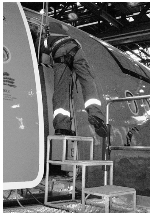
6 Protection contre les chutes lors de l'utilisation d'un escabeau à trois échelons.
