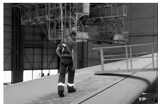
7 Protection contre les chutes après avoir travaillé sur la passerelle de maintenance.
