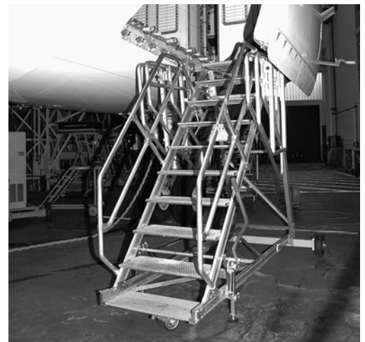
2 Escalier de maintenance protégé contre la mise en mouvement intempesive avec garde-corps baissés.
