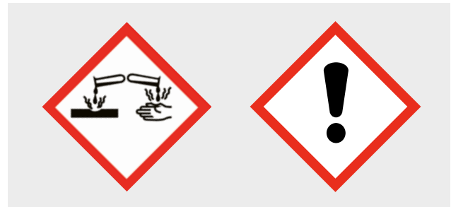
9 Gefahrenpiktogramme weisen auf hautschädigende Eigenschaften der Arbeitsstoffe hin.
