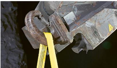
1 Dispositif d'élingage avec un crochet
