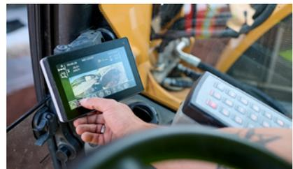
3 Engin de chantier avec caméra de recul
