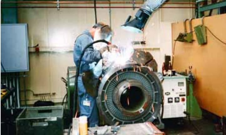
**Fig 1** le soudage à l'arc s'accompagne d'une exposition importante aux UV.
