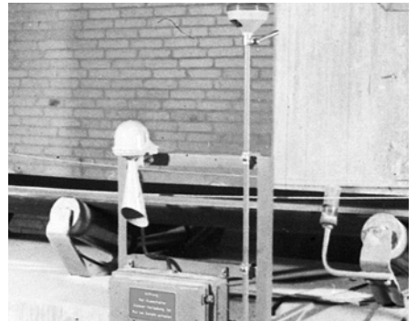
11 Signal optique ou acoustique de démarrage de la machine.
