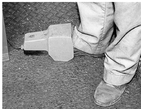
7 Pédale de commande avec capot de protection.
