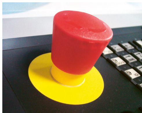
4 Interrupteur d'arrêt d'urgence à bouton-poussoir.
