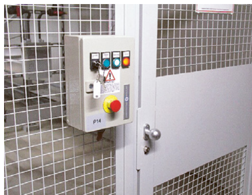
5 Les boutons-poussoirs sont équipés d'une collerette empêchant tout enclenchement involontaire.
