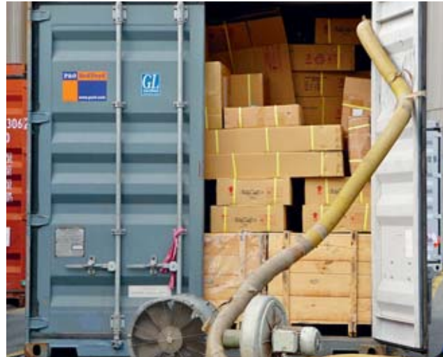
Bild 3: Beispiel für künstliche Entlüftung (Quelle: BG Verkehr)
