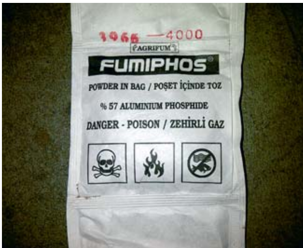
Bild 2: In einem Frachtcontainer gefundene Tüte mit dem Begasungsmittel Aluminiumphosphid (setzt Phosphorwasserstoff frei bei Kontakt mit Luftfeuchtigkeit)
