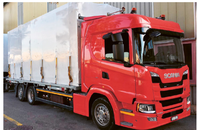
2 Immobilisation du plateau interchangeable par verrouillage twist-lock. Bâche de protection pour le transport et contre les intempéries.
