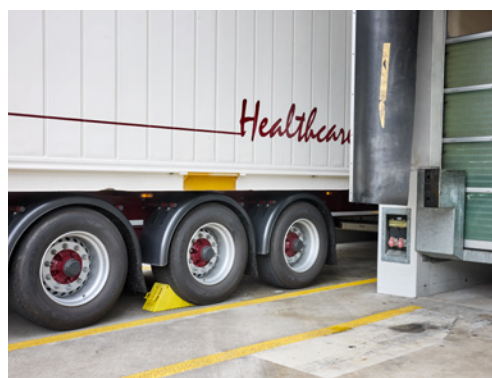
7 Con un cuneo bloccaruote gli addetti al carico delle merci sono sicuri che il veicolo non possa muoversi.
