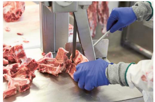
Image 1: utilisation correcte du dispositif servant à exercer une pression
