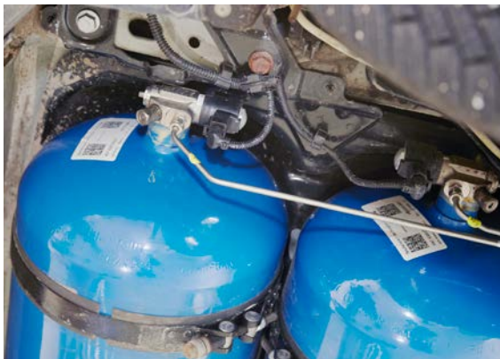
CNG wird bei 200 bar gespeichert.
