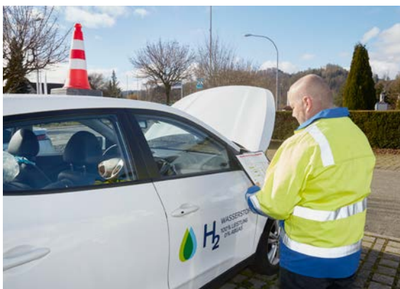
Gasfahrzeuge werden im Falle einer Panne mit einer Pylone auf dem Dach gekennzeichnet.
