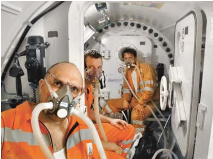
Figure 11 Décompression avec oxygénation dans le sas du personnel d'un tunnelier.
