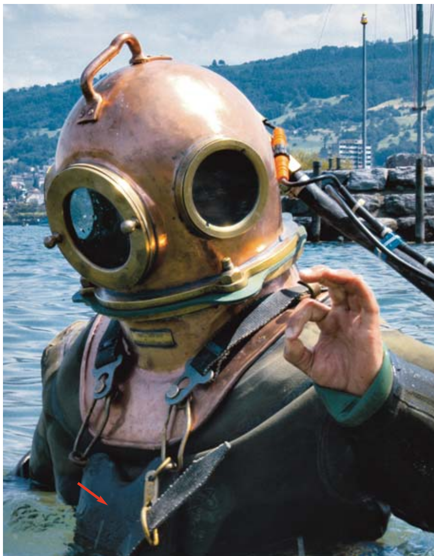
Figure 4 Scaphandre à casque ancien: casque en cuivre avec plastron muni d'un poids en plomb (flèche). Alimentation en air par un tuyau partant de la surface.
