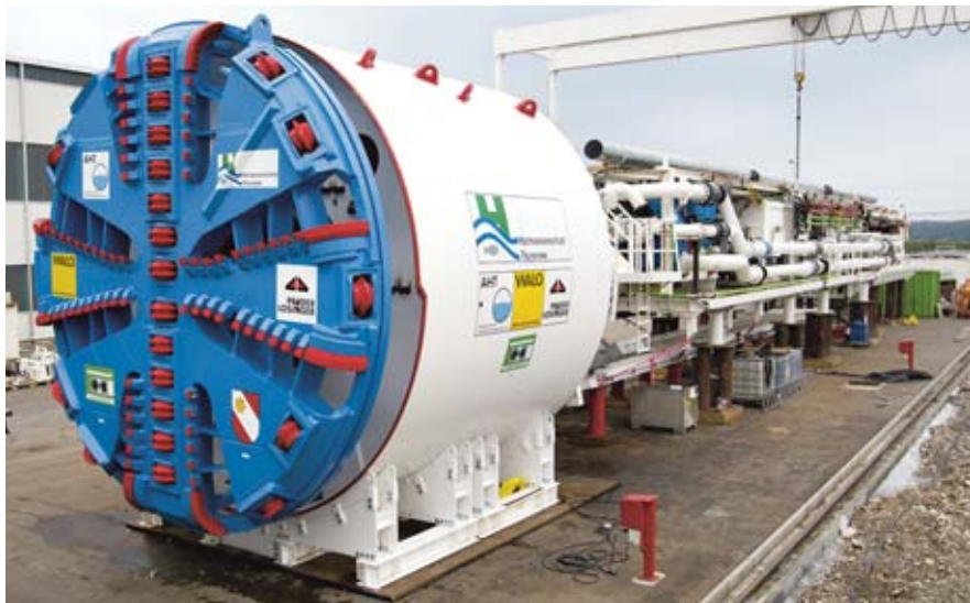
Figure 9b Vue de l'avant en direction de la roue d'abattage, avec le bouclier (peint en blanc) et derrière celui-ci le train suiveur (sous le portique) contenant les installations de la machine et le matériel de tubage du tunnel.
