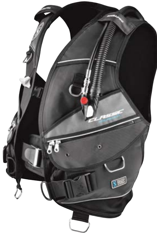
Figure 20 Le gilet stabilisateur est un élément important de l'équipement des plongeurs sportifs. Il peut être rempli d'air à l'aide d'un petit tuyau à partir de la bouteille de gaz respiratoire (non visible dans l'illustration). On peut aussi le gonfler en soufflant avec l'embout intégré (raccord de gonflage sur le tuyau plissé). Le bouton rouge permet de laisser échapper l'air. Le plongeur peut ainsi contrôler sa flottabilité à toutes les profondeurs. Ill.: société Scubapro
