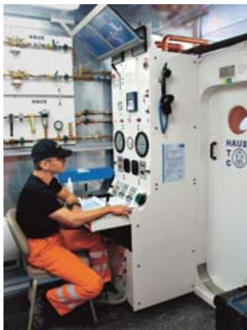
Figure 23b Poste de commande et de surveillance pour l'opérateur du caisson.
