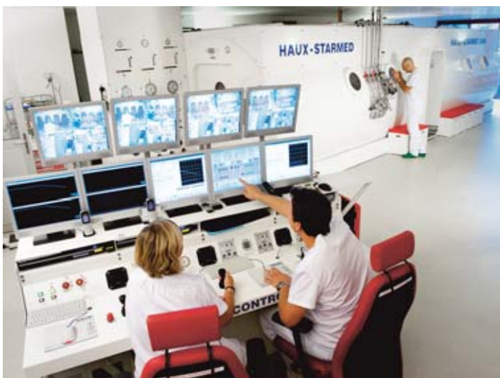
Figure 24a, b Caisson thérapeutique à l'hôpital, pouvant accueillir dans chaque unité 8 patients assis ou 3 couchés pour une ventilation à l'oxygène pur. Ce dispositif nécessite d'importants moyens de surveillance.
