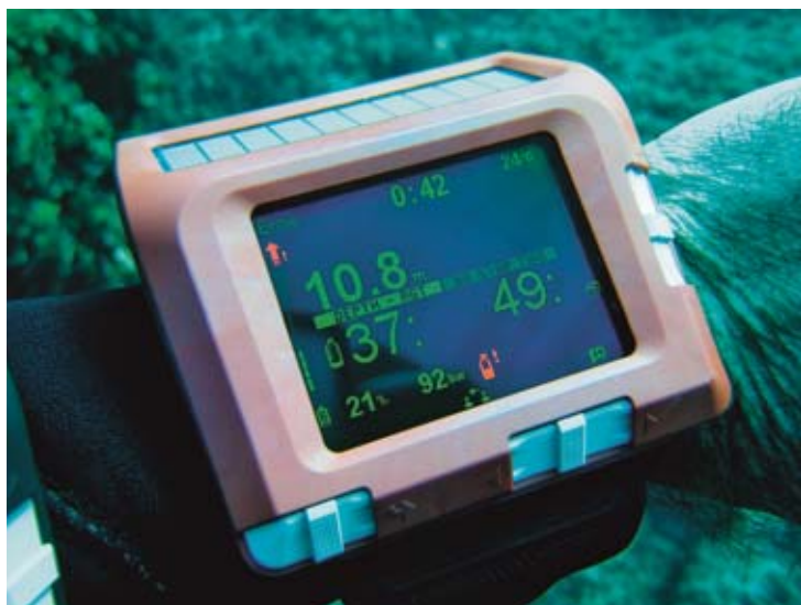
Figure 21 Ordinateur de plongée, un instrument fixé au poignet ou à un tuyau d'air comprimé qui enregistre, entre autres, le temps de plongée, la pression ambiante et la profondeur instantanée, ainsi que la réserve restante de gaz respiratoire. Sur cette base, l'appareil indique au plongeur jusqu'à quand il peut se maintenir en deçà du temps zéro ou quels paliers de décompression il devra respecter.
