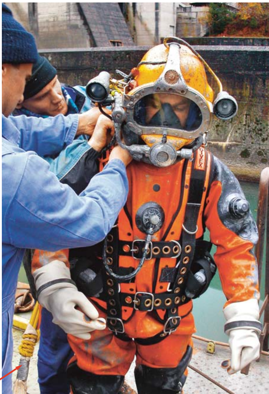
Figure 6a Plongeur professionnel équipé pour les travaux de construction et de montage sous l'eau, avec une solide tenue de plongée étanche et un casque en composite de fibres de verre ou de carbone avec masque respiratoire intégré, téléphone et lampe. Alimentation depuis la surface par un tuyau (flèche). Nécessite du personnel auxiliaire.
