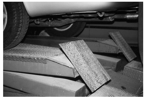
4 Dispositif d'arrêt se déclenchant automatiquement pendant la montée de l'élévateur.
