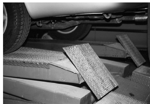
4 Dispositif d'arrêt se déclenchant automatiquement pendant la montée de l'élévateur.
