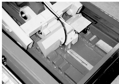
3 Arrêt de sûreté contre les descentes intempestives.
