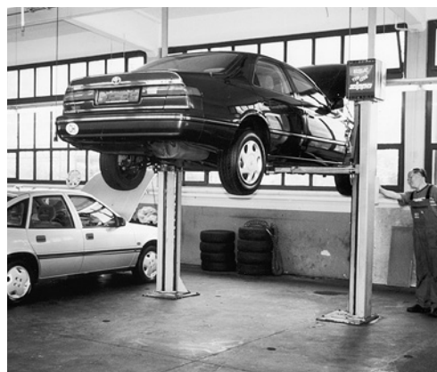
2 Cette installation est bien visible lorsqu'on l'utilise et n'occasionne aucun risque de coincement.
