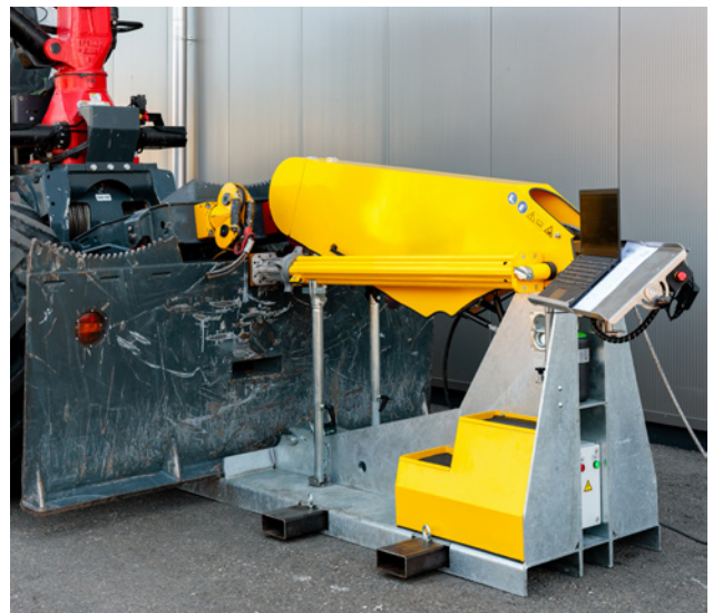
1 Banco di collaudo per la misurazione della trazione e della tenuta del freno.
