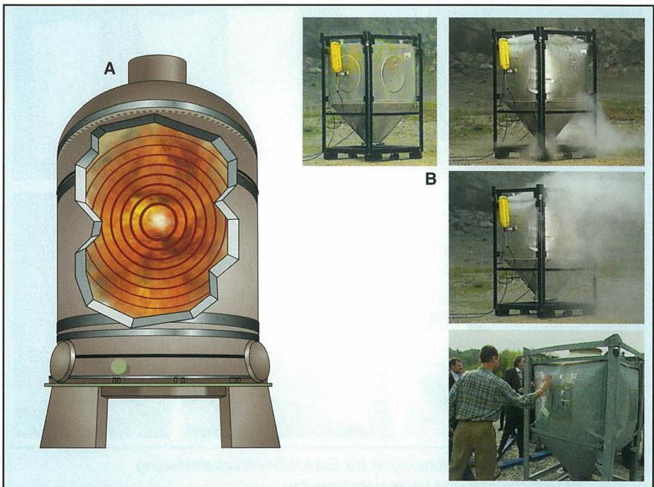
Bild 10 : Beispiele von explosionsfesten Behältern - A: explosionsdruckfeste Bauweise; B: explosionsdruckstossfeste Bauweise, vor und nach dem Explosionsereignis
