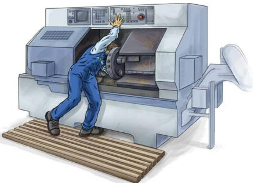
Der Verunfallte war zwischen Werkzeugrevolver und Spindel in der Maschine eingeklemmt.
