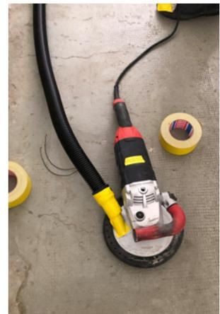
**4** Von Hand geführter Winkelschleifer mit Quellenabsaugung
