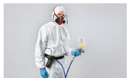
3 Appareil à air comprimé avec demi-masque, combinaison de protection et gants de protection
